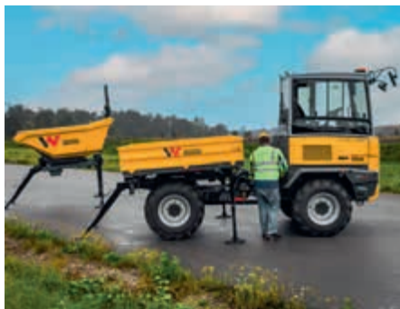
Durch den Austausch der Mulde: Erweitert sich die Aufgabenvielfalt des Dumpers.
